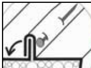
RYSUNEK 2 Łączenie na gwoździe
