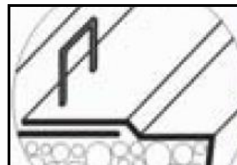
RYSUNEK 3 Łączenie na pręty w kształcie litery U
